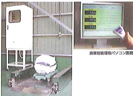
自動計量台秤（ロードセル）
